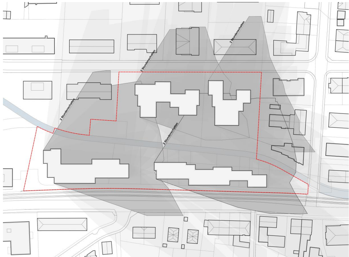
Abbildung 27 Schattendiagramm 2-Stundenschatten Baubereiche A1 + A2 und Baubereiche B1 + B2 Quelle: Salathé Architekten Basel
