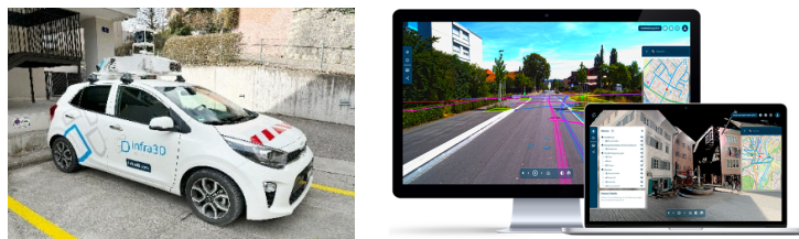
Messfahrzeug der iNovitas AG und infra3D Software, Panoramabilder und Punktwolkenpanorama
