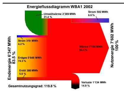
Um den Anteil an Umweltenergie wieder zu steigern, wurde 2001 eine zweite Wärmepumpe gebaut. Diese nutzt die Wärme des ungereinigten Abwassers der Kanalisation in der Damit Baslerstrasse. stiea allerdings der Eigenverbrauch an Strom, weshalb die finanziell interessante Rücklieferung an die EBM um über 60% gesunken ist. Der Anteil an Umweltenergie liegt nun wieder bei über 30% und ist mit 2'389 MWh fast gleich hoch wie der Gesamtwärmeabsatz im Jahre 1987.
