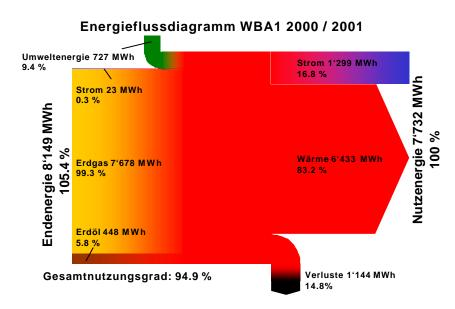
1992 wurde das zweite Gas-Blockheizkraftwerk eingebaut. Damit wurde ein Stromüberschuss generiert, der verkauft werden konnte. Der Anteil an Umweltenergie ist in dieser Periode auf ca. 730 MWh/a gesunken. Da der Wärmeabsatz gegenüber 1987 um mehr als das Doppelte gestiegen war, machte die Umweltenergie nur noch ca. 10% aus.
